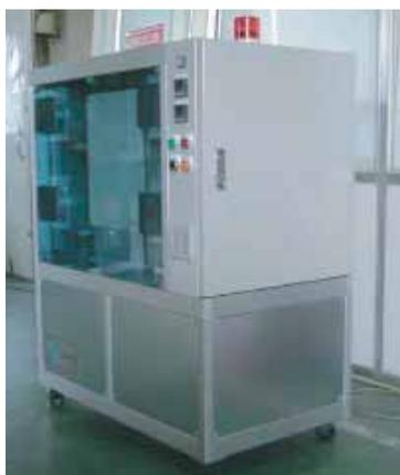
実証試験機 60m³/h 1010(L)×600(W)×1170(H)(mm)
