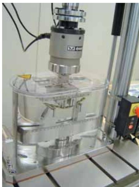
図3 骨プレートの試験の様子
