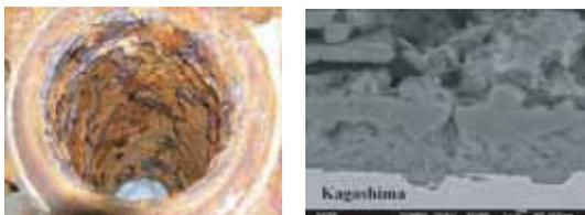
図1 腐食配管の例 腐食試験片の断面微細構造
